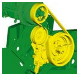
Redukcija brzine power separatora
