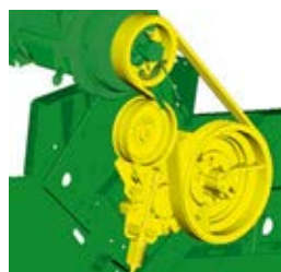
Redukcija brzine power separatora.
