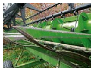
Labavi podizači useva mogu da dovedu do oštećenja na kombajnu
