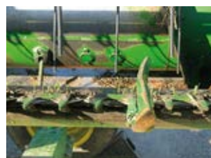
Polegnuti usevi neće se podići sa tla i gubici će biti veći
